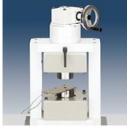
Elektromagnet mit Heizpolen
